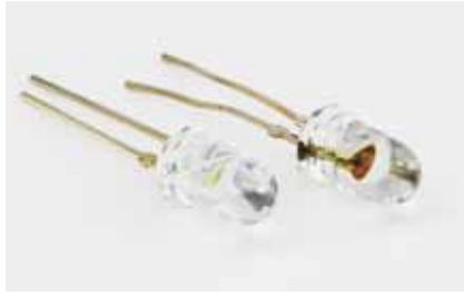
図 10.3.1 過電流が流れて焦げた LED
